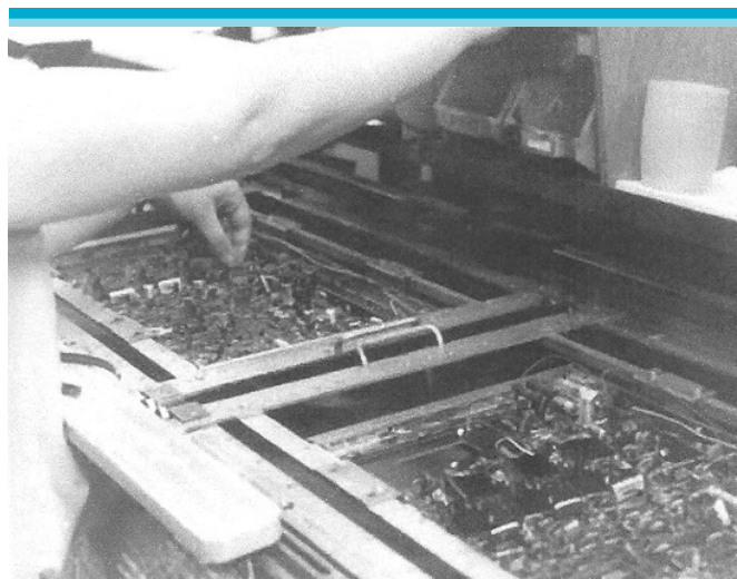
Figura 4: Modo operatorio “teórico” en el puesto de inserción en la línea de montaje de productos electrónicos: movimientos en alternancia (Laville, Teiger & Duraffourg, 1972; Teiger & al., 2006, p. 54).
